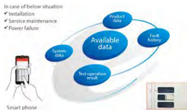
Obr. 5 - Wave Tool dokáže načíst údaje ze systému do aplikace v zařízení s operačním systémem Android. Významná podpora při instalaci, servisu nebo zjišťování chybových hlášení
