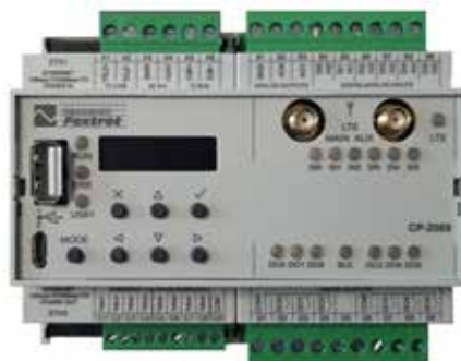
Obr. 2 - V šíři šesti modulů nabízí CP-2005 na DIN liště navíc 6 univerzálních (AI/DI) vstupů, 2 analogové výstupy (AO) a 6 reléových výstupů (RO). Je možné ho objednat i s interní WIFI nebo s LTE modemem pro bezprostřední připojení do internetu kdekoliv
