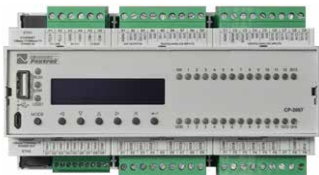
Obr. 3 - V šíři devíti modulů nabízí CP-2007 jednak již větší a pohodlnější OLED displej pro systémovou a uživatelskou komunikaci. Je k dodání také ve verzi s Wi-Fi a s LTE modemem. Disponuje 14x univerzálními (AI/DI) vstupy, z nichž 4 mohou být jako rychlé čítače a dva lze přepnout na analogové výstupy (AO), a 1x DI vstupem na úrovni 230V AC. Na straně výstupů je k dispozici 11x relé (RO/3 A) a 2x analogové výstupy (AO), které lze přepnout do módu s PWM na úrovni 24 V
