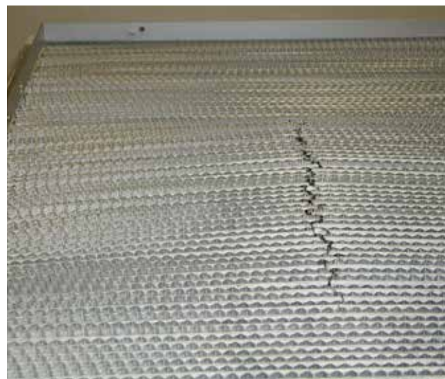
Obr. 2 - U HEPA filtru zanášeného na tlakový spád přes 1400 Pa se prohnul celý složenec a tímto namáháním se filtrační papír přetřhl
