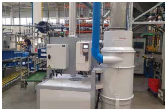
Obr. 2 - Použita vysoce výkonná odsávací centrální jednotka řady I4D o příkonu 15 kW vč. frekvenčního měniče s pulsní automatickou regenerací filtru stlačeným vzduchem. Parametry jednotky: Průtok 1685 m 3 /h, podtlak - 315 mbar, plocha filtru 11 m 2 , kapacita prachového odlučovače o objemu 60 l
