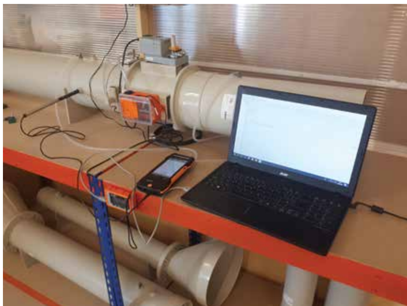
Obr. 3 - Výroba variabilních regulátorů průtoku je vždy zakončena tzv. kalibrací – tedy nastavením V_{krit}
