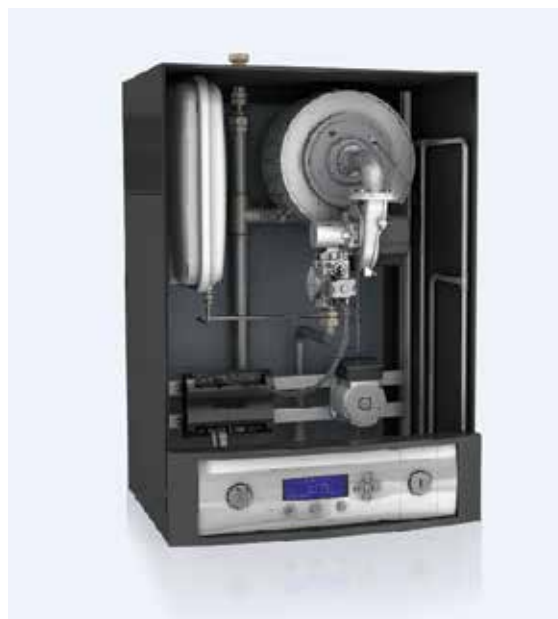
Obr. 1 - Kondenzační kotel ve svém principu může pracovat také s vodíkem, ale pouze pokud jsou komponenty odpovídajícím způsobem upraveny; vodík hoří jinak než zemní plyn
