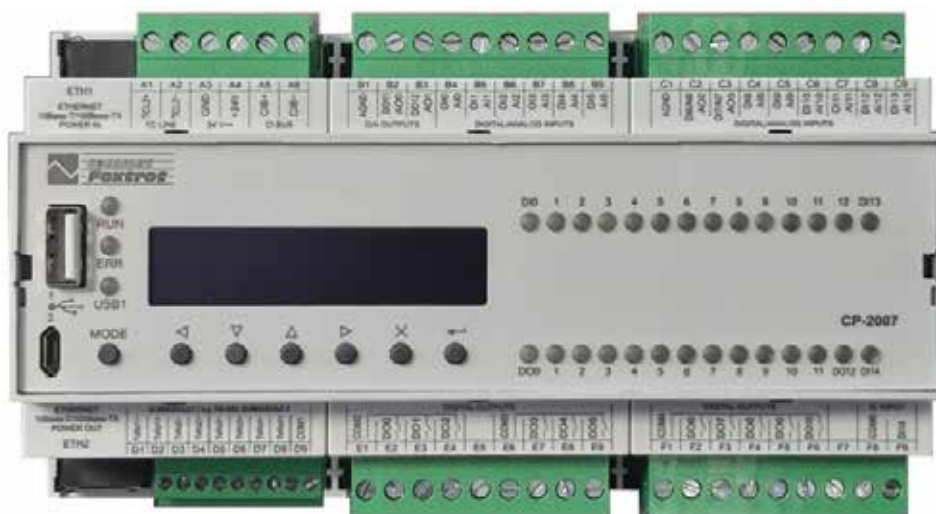
Obr. 3 - V širší devíti modulů nabízí CP-2007 jednak již větší a pohodlnější OLED displej pro systémovou a uživatelskou komunikaci. Je k dodání také ve verzi s WiFi a s LTE modemem. Disponuje 14x univerzálními (AI/DI) vstupy, z nichž 4 mohou být jako rychlé čítače a dva lze přepnout na analogové výstupy (AO), a 1x DI vstupem na úrovni 230V AC. Na straně výstupů je k dispozici 11x relé (RO/3 A) a 2x analogové výstupy (AO), které lze přepnout do módu s PWM na úrovni 24
