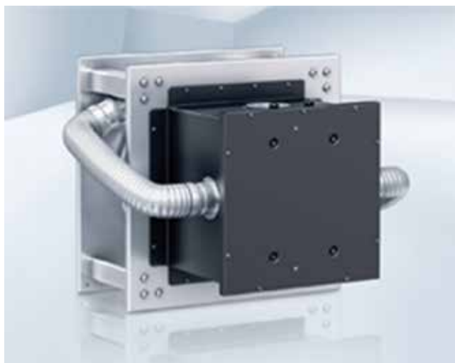
Obr. 1 - Speciálně optimalizovaný ventilátor pro odsávání z kuchyně: motor RadiPac byl zapouzdřen tak, aby byl mimo proud vzduchu
