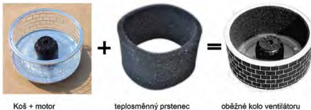
Obr. 2 - Sestava rekuperátoru Frivent
