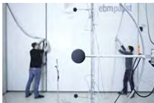
Obr. 5 – Měření zvuku se provádí pomocí mikrofónů
