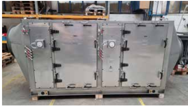
Obr. 4 – Filtrační jednotka pro zachyt radioaktivních aerosolů
