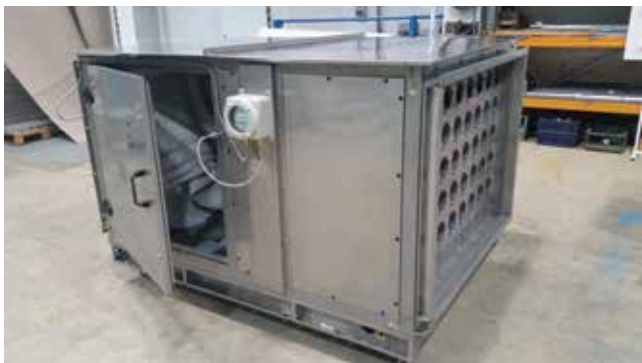
Obr. 2 – Filtrační zařízení do prostředí s nebezpečím výbuchu pro zachyt kyselinových výparů
