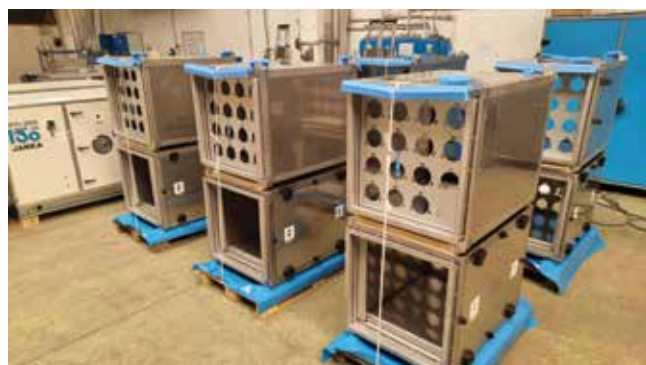
Obr. 7 – Filtrační celo-nerezové zařízení se svařovanou kostrou s dvoustupňovou filtrací pro umístění do potrubní trasy a zavěšení do stropu
