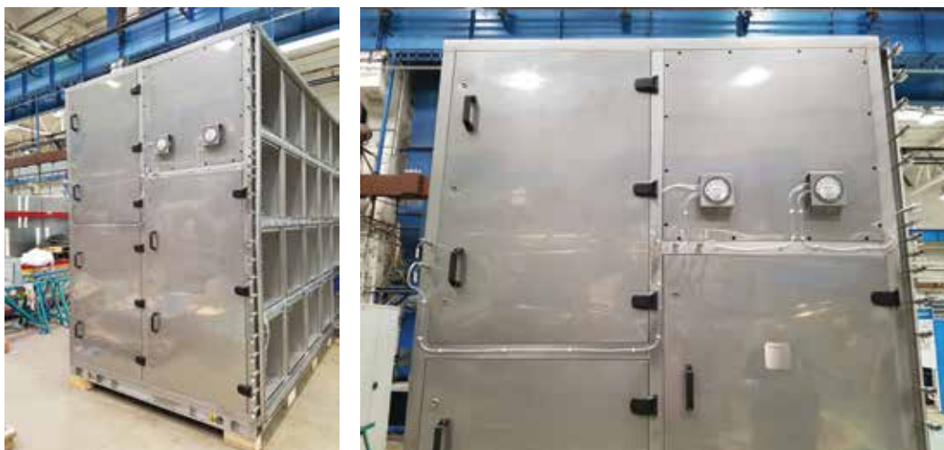
Obr. 1 – Celo-nerezové filtrační zařízení navrženo pro odfiltrování kontaminovaných prachových částic
