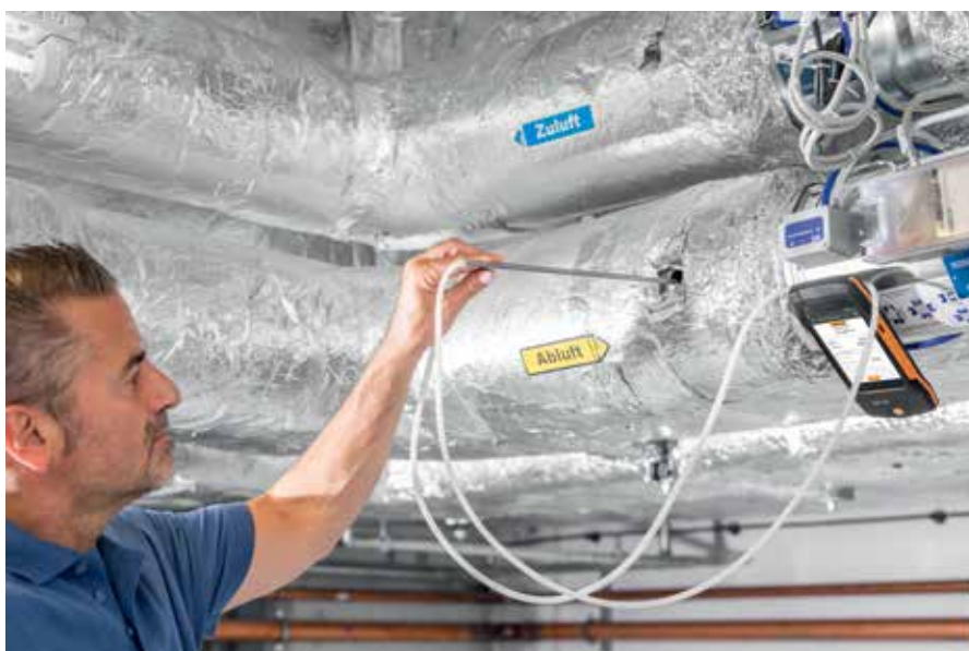
Obr. 2 – Testo 400 a pitotova trubice (Pitotova trubice z ušlechtilé oceli, délka 350 mm, Ø 7 mm – k měření rychlosti proudění)
