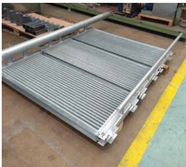
Obr. 1 – Parní ohřivač OPD upravený pro umístění do vzduchotechnické jednotky
