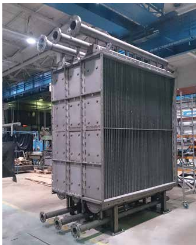
Obr. 6 – Sestava tří nerezových parních ohřívačů vzduchu kdy každý stupeň je navržen pro jiné parametry páry (4/10 a 35 bar)
