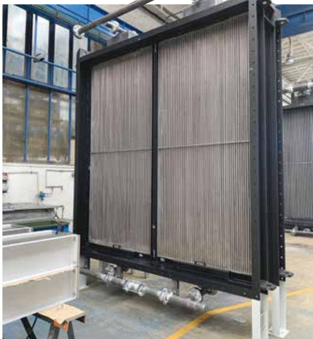
Obr. 6 a 7 – Parní ohřívač a dochlazovač kondenzátu pro ohřev vysokopecního plynu
