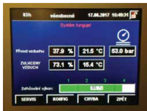
Obr. 2 – Efekt adiabatického chlazení – teplota před a po zvlhčování
