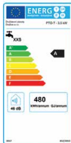
Obr. 2 – Energetický štítek se zátěžovým (vytáčecím) profilem u průtokového elektrického ohřivače vody Výrobek: PTO-T výrobce Družstevní závody Dražice, s.r.o. XXS = zátěžový profil A = energetická třída účinnosti 46 db = hladina akustického výkonu 480 kWh/annum = roční spotřeba elektrické energie
